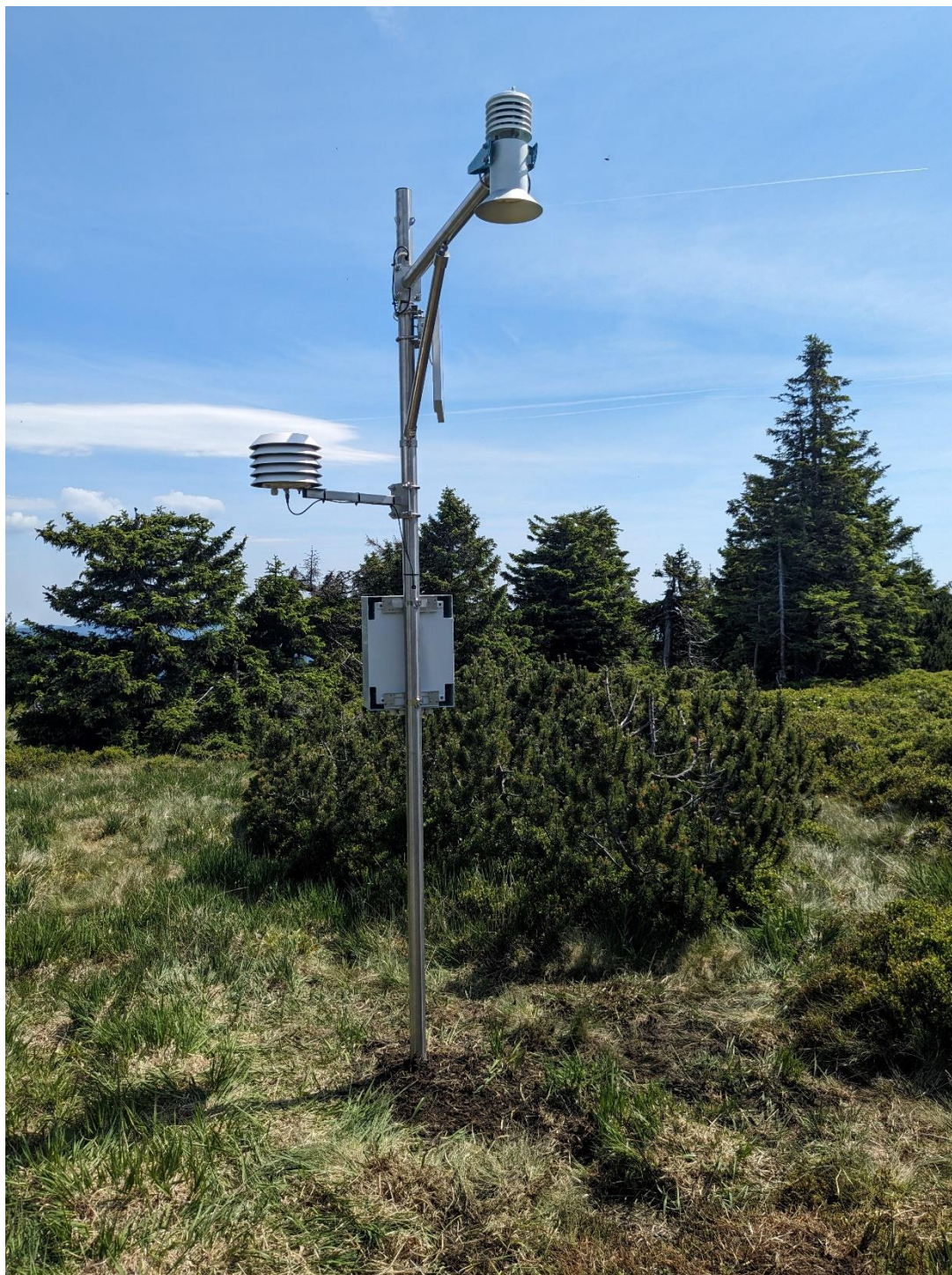
Obr. 23 Automatická sněhoměrná stanice Malý Děd (1365 m n. m.), foto: Veronika Šustková
