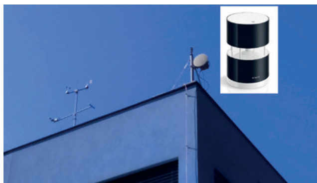
Obr. 4 Umístění čidel na pozemku pobočky ČHMÚ v Hradci Králové. Na střeše vlevo jsou umístěna větroměrná anemoidla ČHMÚ, vpravo ultrazvukové čidlo Netatmo, jehož detail je ve výřezu vpravo nahoře.
