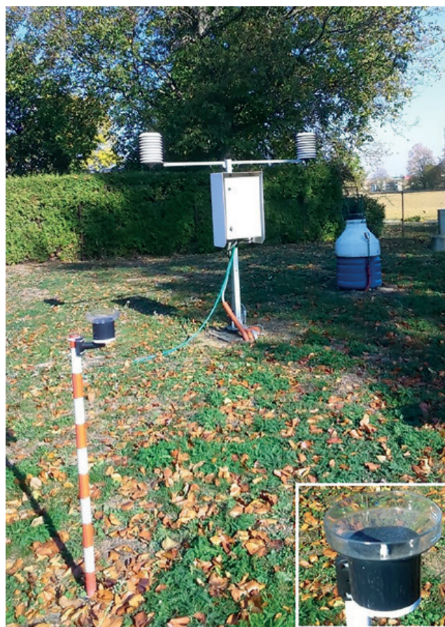
Obr. 3 Umístění čidel na pozemku pobočky ČHMÚ v Hradci Králové. Vepředu člunkový srážkoměr Netatmo, který je vidět v detailu ve výřezu vpravo dole. Pod radiačním štítem nalevo je umístěn venkovní modul pro měření teploty a vlhkosti vzduchu Netatmo. Pod radiačním štítem napravo je umístěno čidlo pro měření teploty a vlhkosti vzduchu ČHMÚ. Vpravo vzadu je váhový srážkoměr ČHMÚ.
