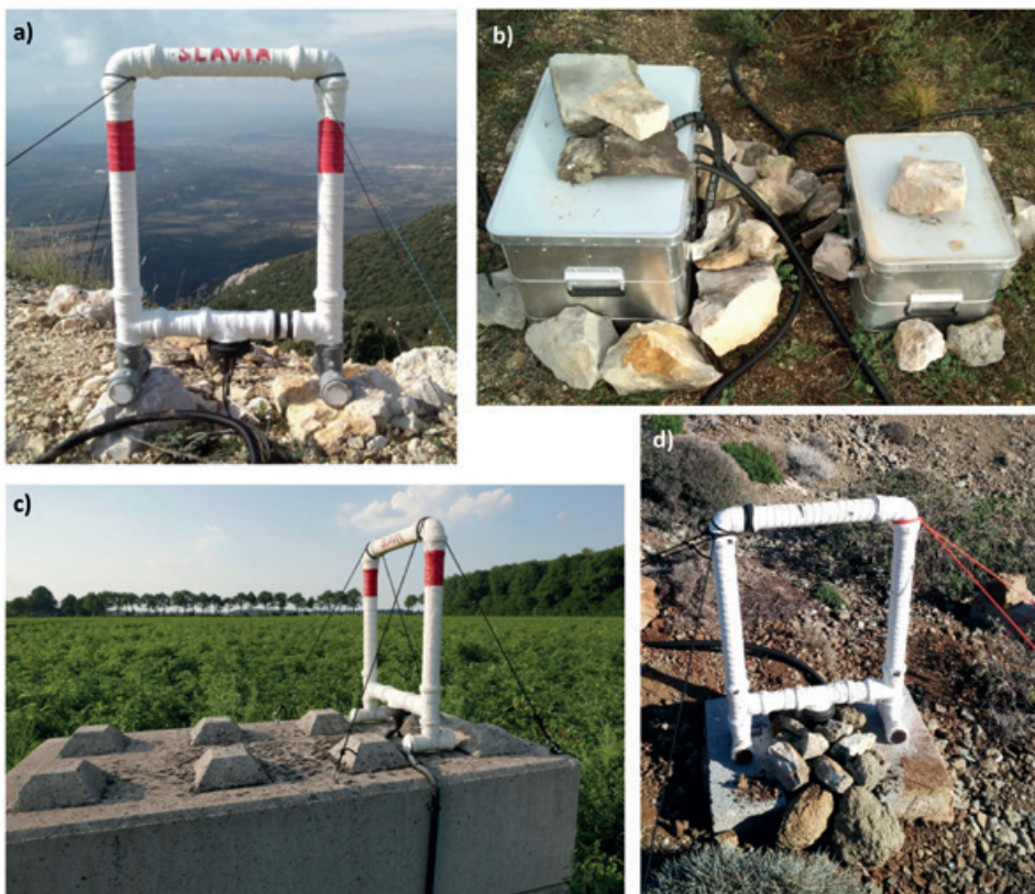
Obr. 1. a) Jedna ze čtyř magnetických stíněných smyček SLAVIA umístěných na vrcholu La Grande Montage, Francie (1 028 m; 43,94° N; 5,48° E). b) Akviziční a napájecí jednotka tamtéž. c) Jedna ze dvou antén SLAVIA nainstalovaných v blízkosti holandské obce Ter Wisch (52,92° N, 7,09° E). d) Anténa SLAVIA měřící na Korsice v blízkosti obce Ersa (550 m; 42,97° N; 9,38° E).
