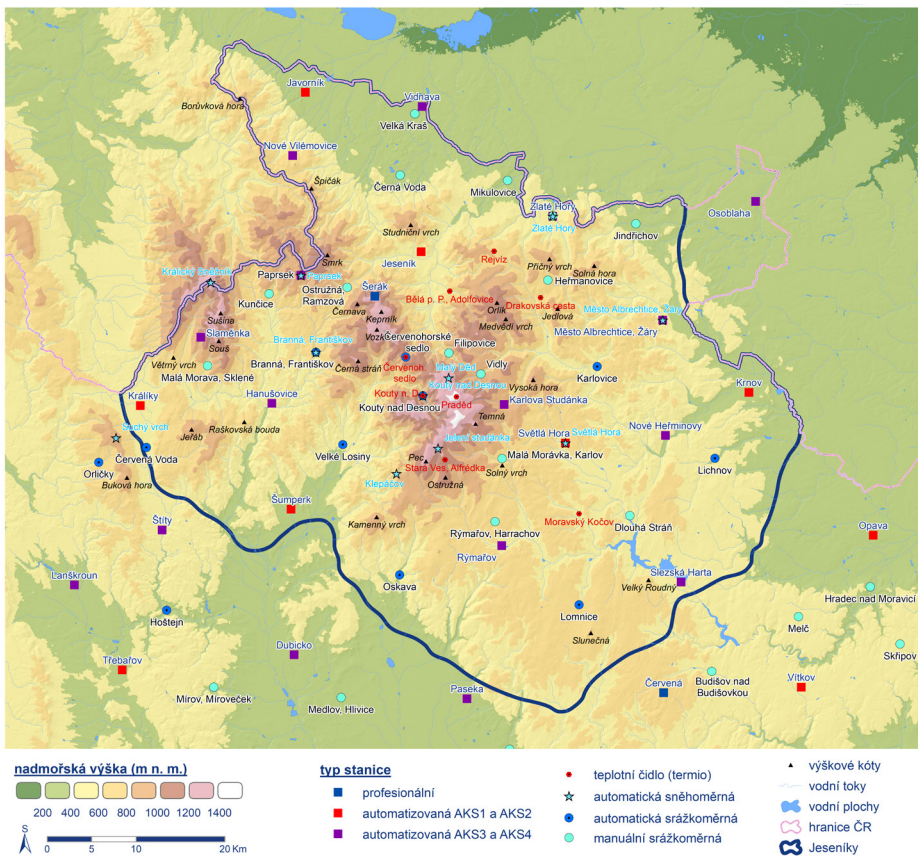
Obr. 2 Jeseníky definované pro klimatologická zpracování a mapa aktuální meteorologické staniční sítě ČHMÚ. Stanice typu AKS1 a AKS je základní klimatologická stanice, zpravidla s úplným programem pozorování dobrovolnických stanic ČHMÚ. Stanice typu AKS3 a AKS4 je klimatologická stanice s redukovaným programem pozorování dobrovolnických stanic ČHMÚ (chybí měření a sledování některých meteorologických prvků, nebo je stanice bez pozorovatele).
