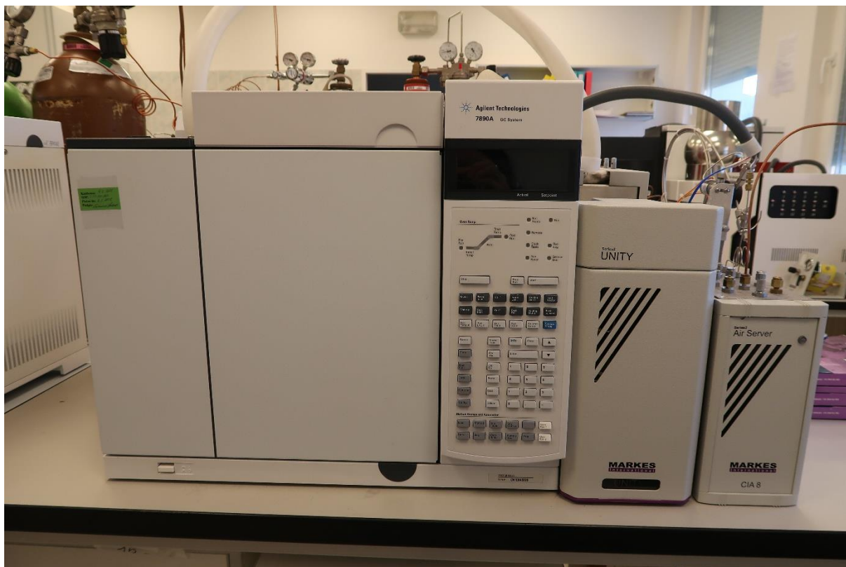
Obr. 11 Plynový chromatograf s FID detektorem pro stanovení těkavých organických látek (VOC) ve venkovním ovzduší (foto: CLI Praha Libuš)
