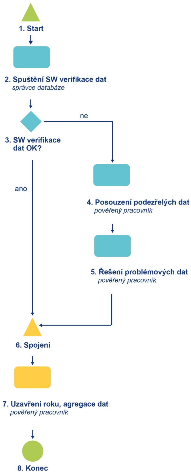
Obr. 16 Schéma verifikace imisních dat v ISKO
