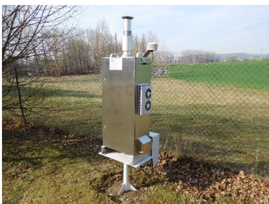
Obr. 7 Stanice MIM Vyškov – vzorkovač (foto: P-ČHMÚ Brno)
