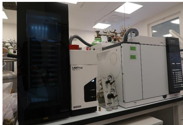
Obr. 14 Plynový chromatograf pro stanovení benzenu ze sorpčních trubiček (foto: CLI Praha Libuš)
