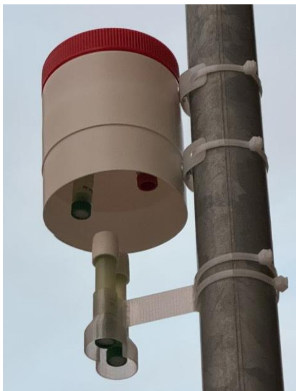
3D držák pasivního vzorkovače. Model STL připravil M. Lažan ze Senzorvzduchu z.s. a je volně dostupný pod licencí Creative Commons (4.0 International License) – Attribution z https://www.printables.com/model/653645-no2-tube-holder
