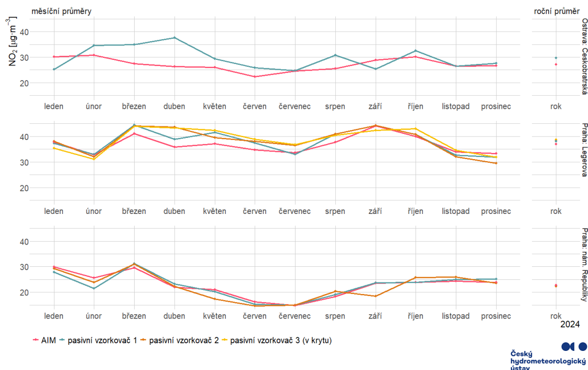
Obrázek 5 Srovnání měsíčních průměrů NO 2 z pasivních vzorkovačů a z automatizovaných stanic státní sítě imisního monitoringu (AIM).
