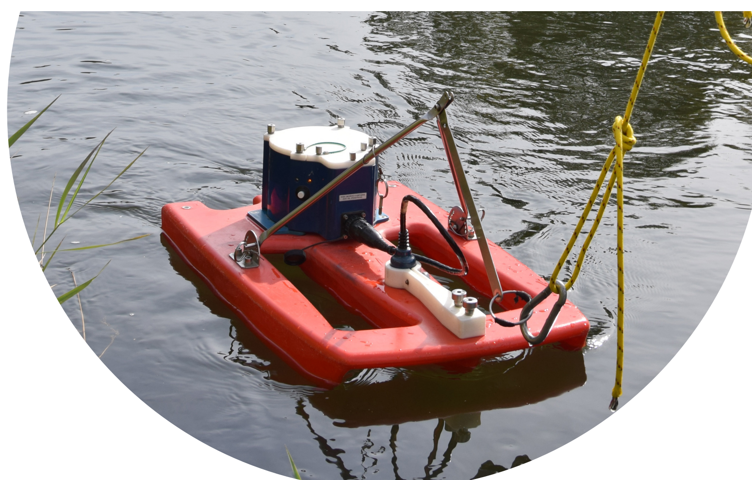
Pro nepříliš hluboké toky (minimální hloubka 20 cm) se využívá Stream Pro. V případě potřeby zvládně obsluhu tohoto plováku jeden pracovník.
