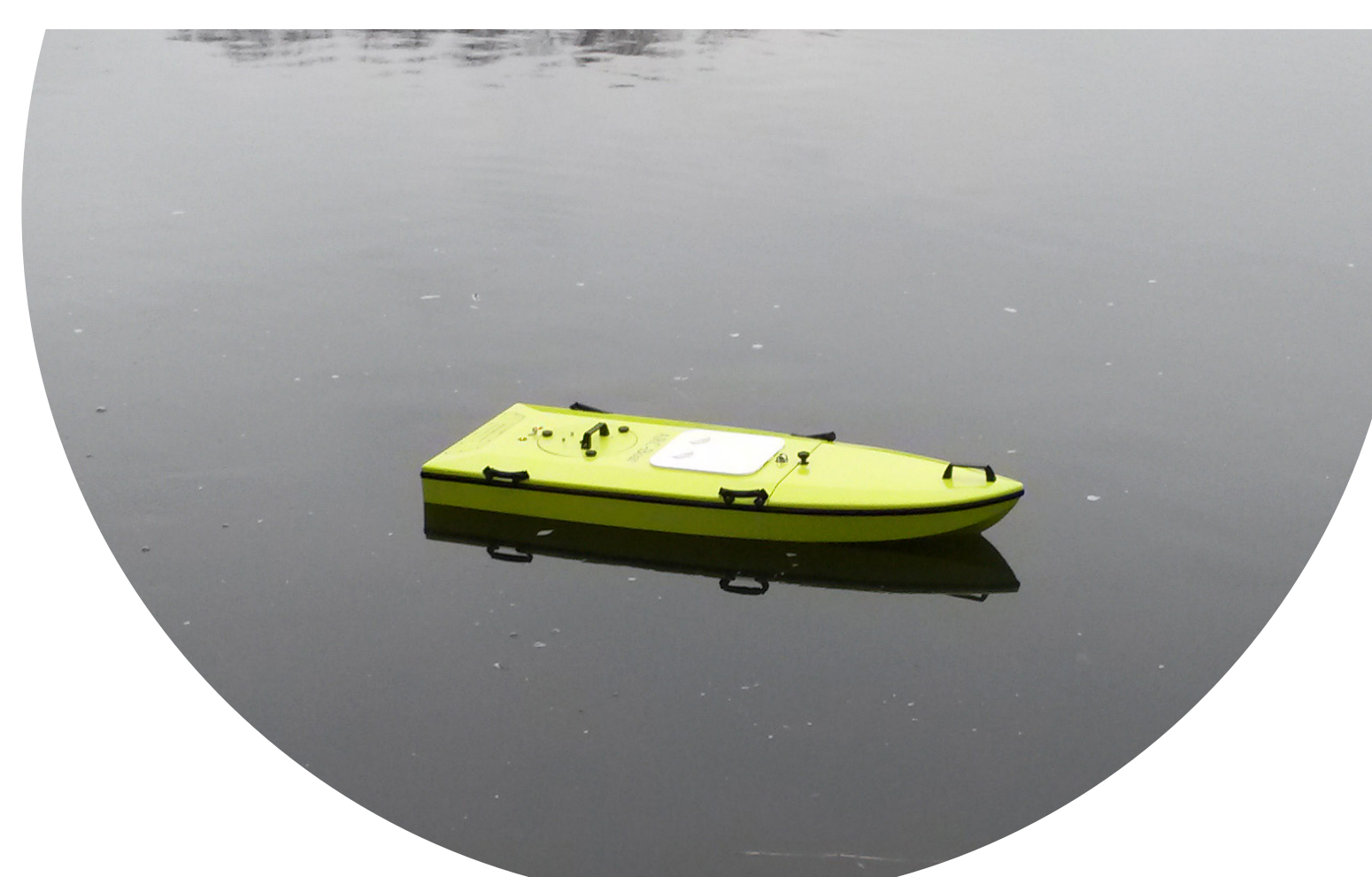
Na velkých řekách (Labe, Vltava), kde není žádný most v blízkosti měřeného profilu, se využívá člun s vlastními motory, který se řídí přes dálkové ovládání.
